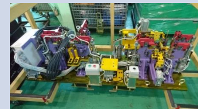
溶接治具：PCUケースアッシー
