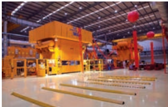
新規導入の順送プレス機（左）とトランスファープレス機（右奥）
