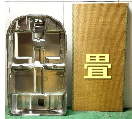
製品サイズが大きく成形難度が高いが、創業以来蓄積された金型技術により最適な工法を創出し製品精度を確保
