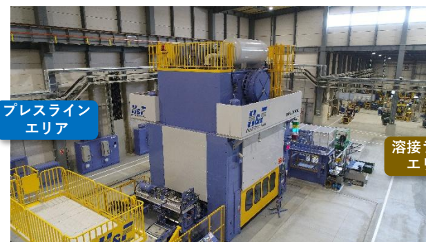
新プレスライン(3000t TRF)+溶接ライン
