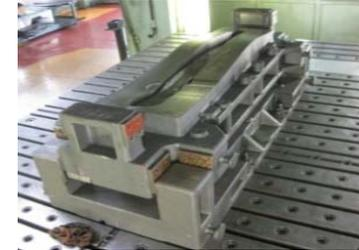
超ハイテン材を成形する金型を、シミュレーションで強度・剛性を評価し最適な金型を設計・製作
