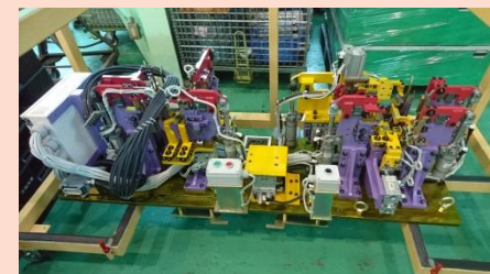
溶接治具：PCUケースアッシー
